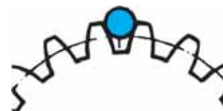
Misura di una dentatura
